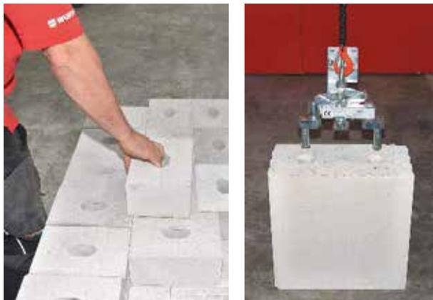
**Bild 21.** Kalksandvollstein oder Kalksandlochstein? a) Griffloch im Kalksandvollstein, b) Kalksandvollstein mit modernem Steinhebegerät (Fotos: Immel)
