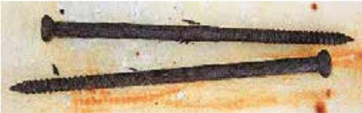
**Bild 64.** Schraube in Meeresnähe ausgelagert, ohne Schutz durch die Dübelhülse (Foto: Künzlen)
