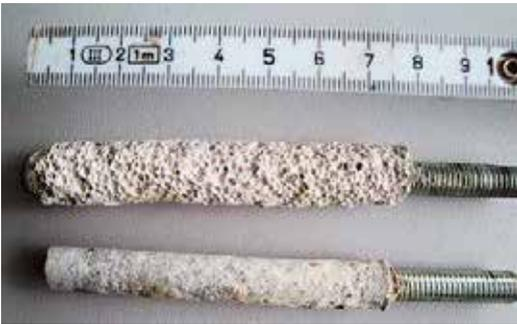
**Bild 71.** Eingeklebte Ankerstange nach Auszug aus einem Porenbetonstein; oben: richtige Bohrlöchrreinigung; unten: falsche Bohrlöchrreinigung (Foto: Lieberum)
