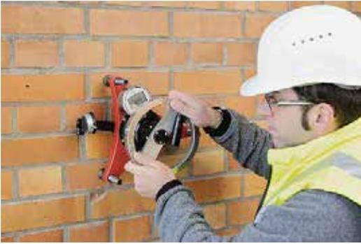
**Bild 83.** (Dübel-)Versuche am Bauwerk zur Bestimmung der Dübel-Tragfähigkeit im tatsächlich vorhandenen Baustellen-Verankerungsgrund (Foto: Adolf Würth GmbH & Co. KG)
