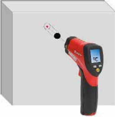
**Bild 35.** Bestimmung der Temperatur immer im Bohrloch am besten mit einem Laserthermometer (Foto: Adolf Würth GmbH & Co. KG; Collage: Scheller)
