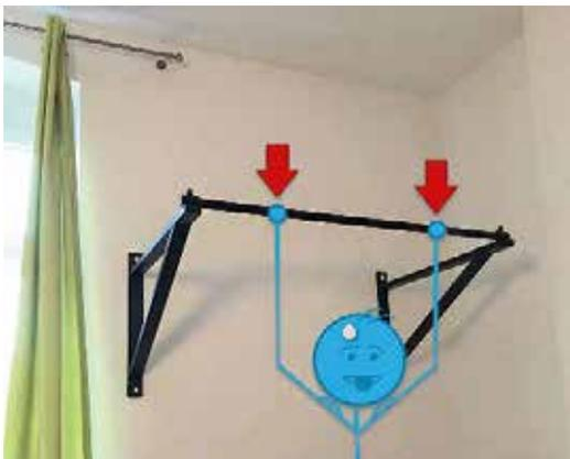
**Bild 56.** Klimmzugstange unter symmetrischer Belastung
