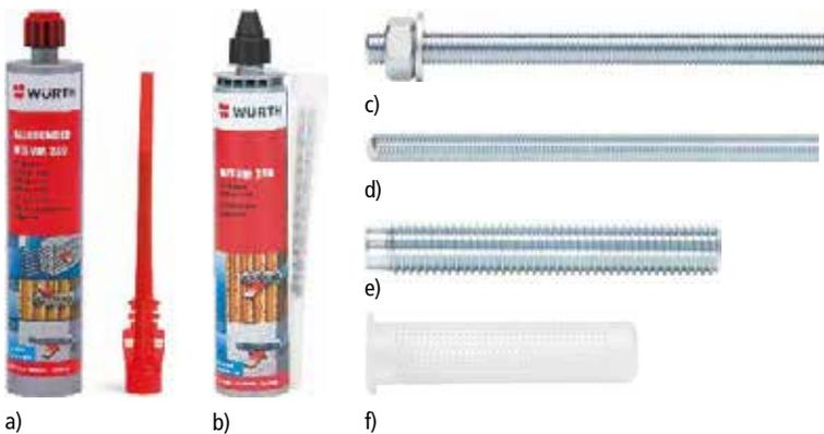
**Bild 65.** Beispiel für zugelassene Metall-Injektionsanker zur Verankerung im Mauerwerk; a) Koaxialkartusche, b) Schlauchfolienkartusche, c) vorkonfektionierte Ankerstange mit Sechskantmutter und Unterlegscheibe, d) Gewindestangen „Meterware“ bzw. „handelsübliche Gewindestange“ jeweils mit Abnahmeprüfzeugnis 3.1, e) Innengewindehülse bzw. Innengewindeanker, f) Siebhülse (Fotos: Adolf Würth GmbH & Co. KG)
