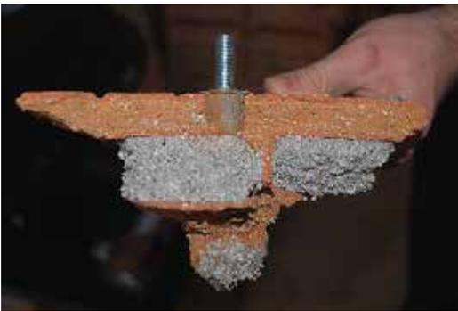
**Bild 39.** Vollständiger Steinausbruch eines Injektionsdübels in Mauerwerk (Foto: Küenzlen)
