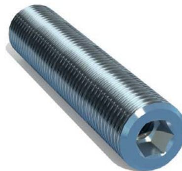
Bild 10: Befestigungssystem BS 100: M16-Gewindestange aus nichtrostendem Stahl mit Innengewinde M8 und Innensechskant zur Montage (Bildquelle: febatec)
